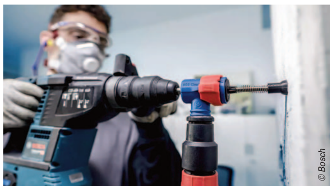
Bosch étudie de près la récupération à la source des poussières de silice cristalline.
